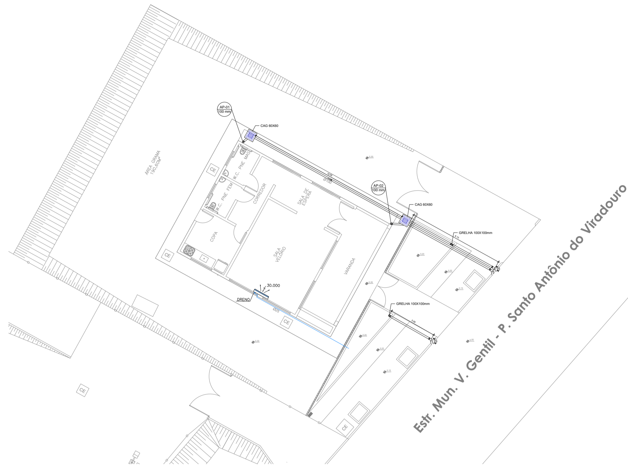
IMPLANTAÇÃO – ÁGUA PLUVIAL ESC. 1:150
