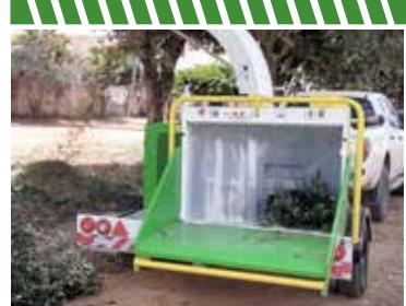
Barra de Açãoamento frete e reverso do rotor. Estrategicamente localizada sobre a calha de alimentação, proporcionando segurança ao operador.
